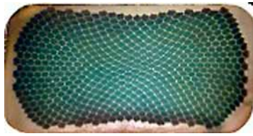
6 pav. Cu-Nb laido skerspjūvis (gaminami kelių skerspjūvių 2×3 mm, 3×5,8 mm, 4×6 mm) (Shikov et al. 2002)
