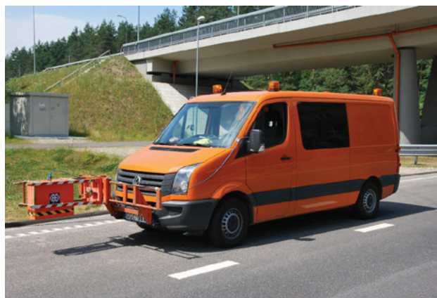
1 paveikslas. 1 GHz bekontaktė (rago formos) antena, sumontuota ant transporto priemonės
